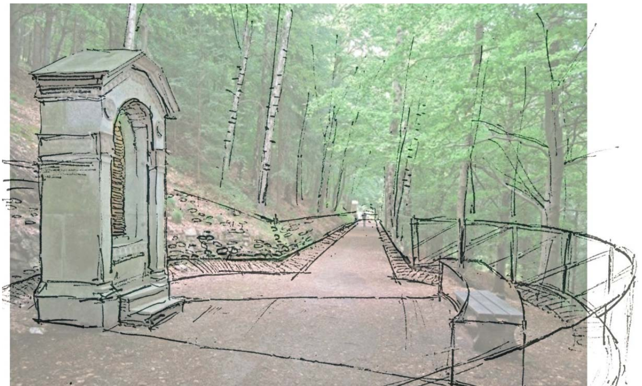
Návrhová skica 1: Řešení prostranství u zastavení (kapličky) křížové cesty (rekonstrukce povrchu v kombinaci MZK a štetovaného povrchu, oprava kamenné zídky za kapličkou, dřevěná oblouková lavice, dřevěné zábradlí)
