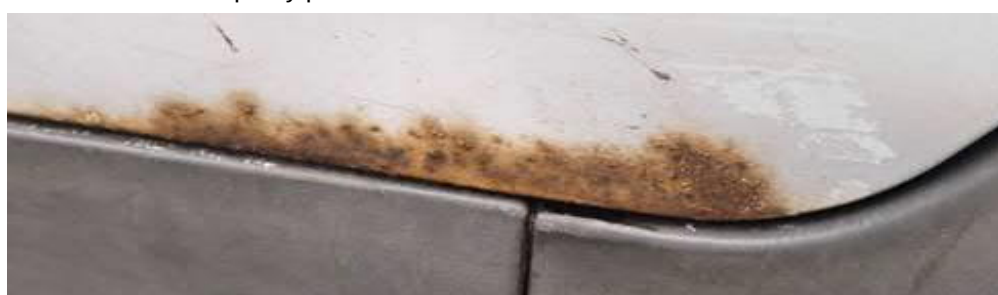
pravé dveře zkorodovány
